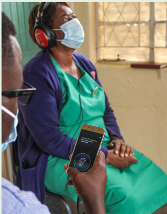
▲ Das tragbare Heartest™ Audiometer ermöglicht die Überwachung der DRTB-Patient:innen, um Anzeichen von Hörschäden frühzeitig zu erkennen. Cordelia Kunzekwenyika
